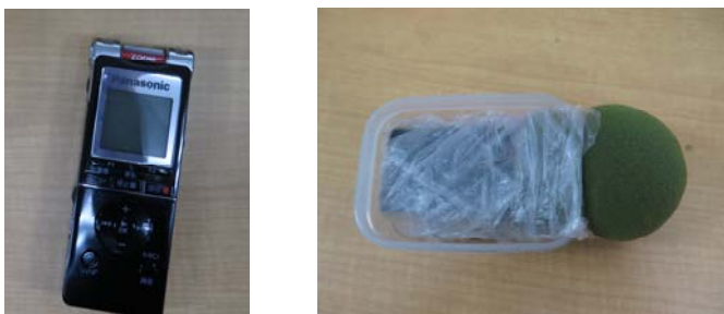
図1. Panasonic社から提供いただいたRR-XXS455と 防風、防水用の簡易ケース
